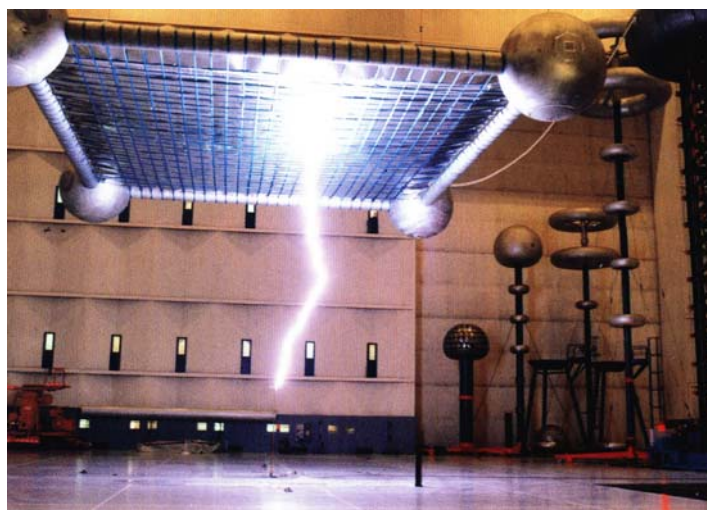
Exemplu de șoc realizat în laboratorul EDF des Renardieres
